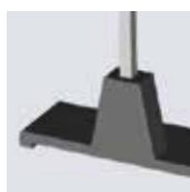
Fotplatta i betong
